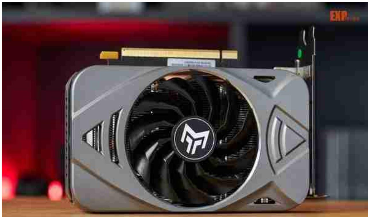
而且它们的功耗也有些微的区别，Radeon RX 6650 XT由于是RX 6600 XT的Refresh版本，提高了GPU的时钟频率和搭配的显存的频率，可以理解为RX 6600 XT的官方超频版，导致它的公版方案的功耗也提升到了180W，并且对于非公版来说，如果再进一步出厂预超频，则功耗会继续飙升，比如本次测试用的XFX Speedster MERC 308 RX 6650 XT BLACK（也就是讯景XFX RX 6650 XT海外版OC），这张卡的实际满载平均功耗我们之前测的是196W，而本次对比的对手影驰RTX 3060金属大师Mini仅有170W。
