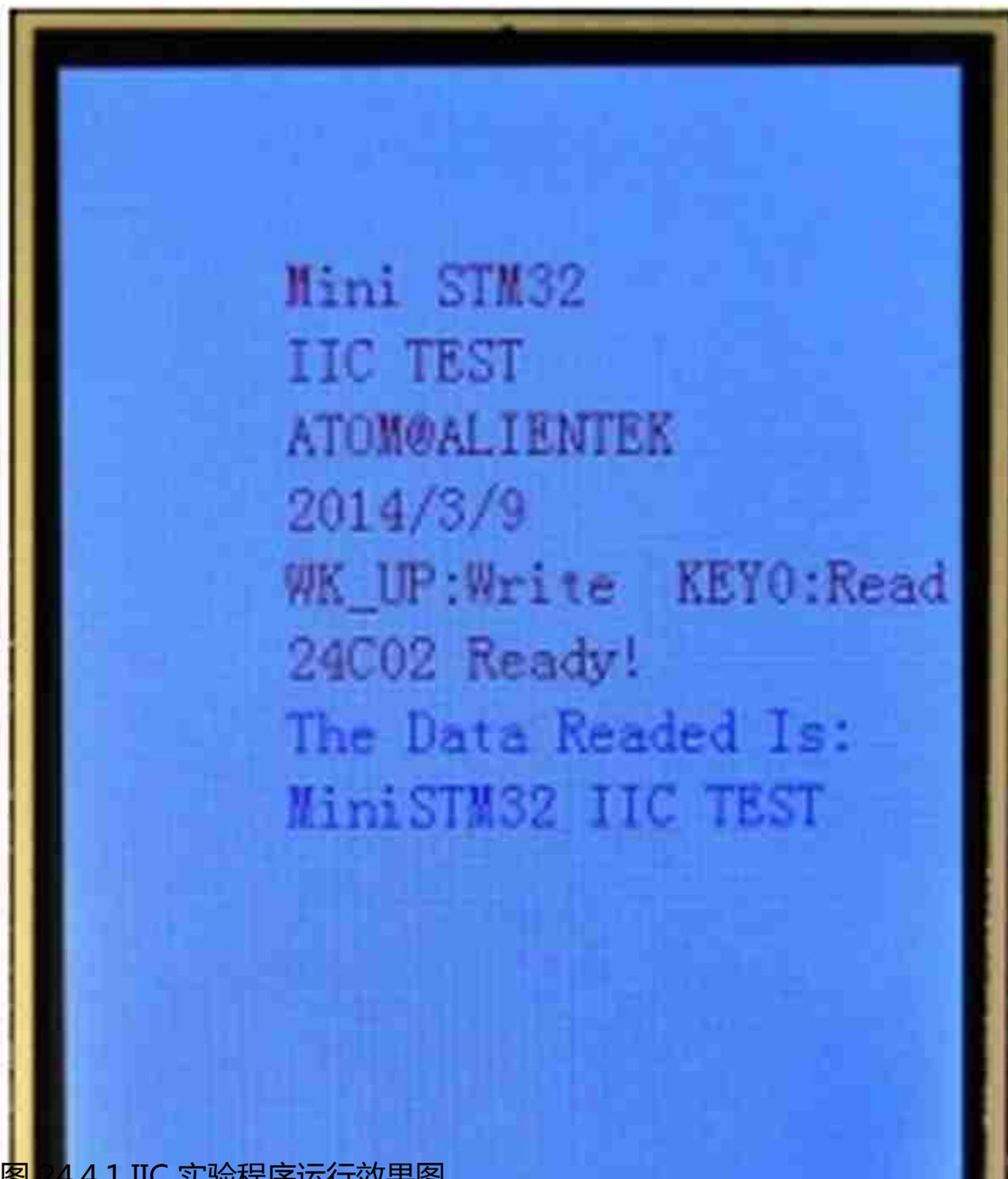
图 24.4.1 IIC 实验程序运行效果图
